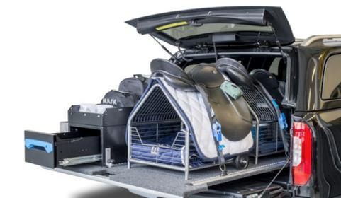
Höhe von 90 cm bieten Platz für spezielle Aufbausysteme. So offeriert Mercedes-Benz Österreich exklusiv einen Schwerlastauszug, eine breite Ladefläche aus robuster Siebdruckplatte mit dickem Raufaser-Teppich bezogen sowie 7 Arretierungsstufen bis zur Endlage.
